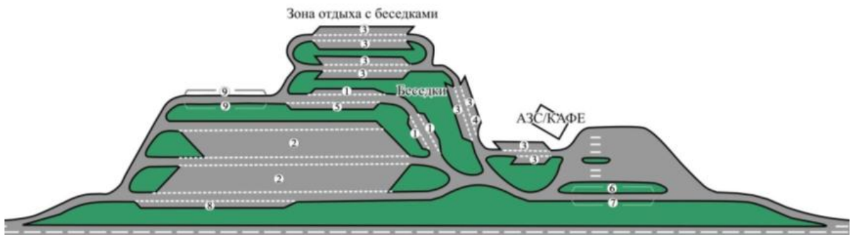
Рисунок Б.2 – Пример (схема) II размещения АЗС совместно с кафе и зоной отдыха
